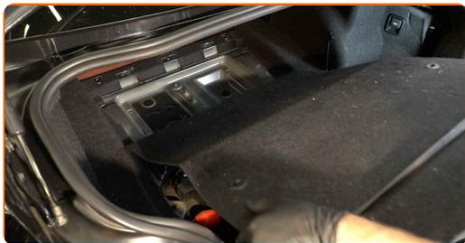
**4** Odvijte pritrdilni element iz osrednje zaščitne plastične plošče. Uporabite Phillips križni izvijač. Uporabite orodje za odstranitev sponke. Uporabite vijačni nastavek T40. Uporabite izvijač z zatikalom.
