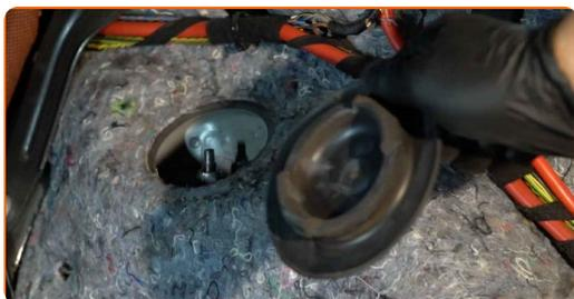
**9** Sprostite zgornji pritrdilni element amortizerja. Uporabite nasadni ključ za blažilnik DDN<sup>®</sup>6. Uporabite nasadni ključ №16. Uporabite izvijač z zatikalom.
