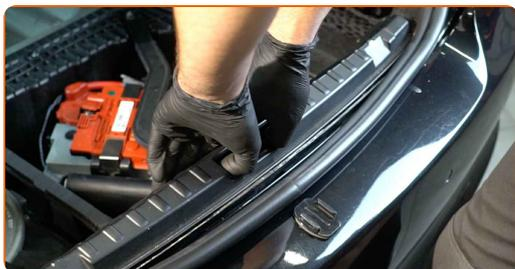
**6** Odvijte pritrdilni element stranske obloge prtljažnika. Uporabite orodje za odstranitev sponke. Uporabite vijačni nastavek T40. Uporabite izvijač z zatikalom.
