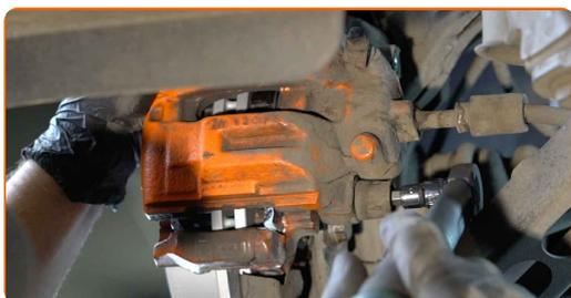
**23** Namestite pokrovčke manšete vodilnih zatičev zavornih čeljusti.
