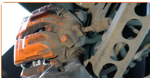
**24** Povežite senzor obrabe zavornih ploščic.
