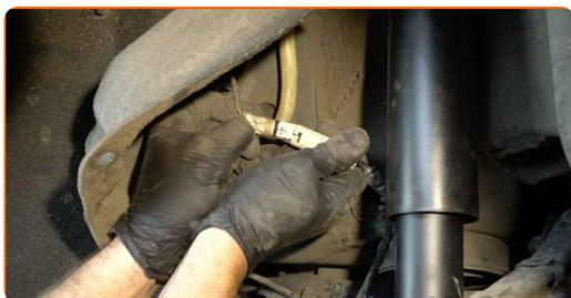
**11** Priključite vtič senzorja za obrabo zavornih oblog.
