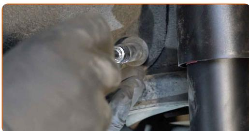
**13** Povežite senzor obrabe zavornih ploščic.
