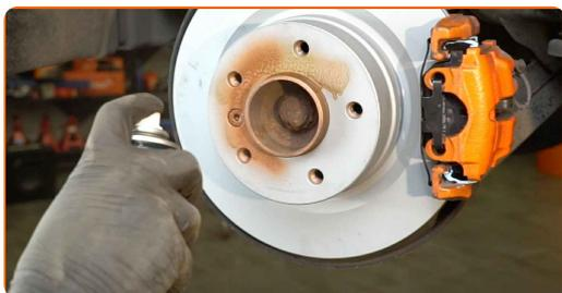
**16** Očistite površino zavornih kolutov. Uporabite čistilo zavor.
