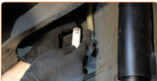
**12** Namestite pokrove blatnikov na sedlo za nameščanje. Privijte pritrdilne elemente. Uporabite nasadni ključ №10. Uporabite izvijač z zatikalom.
