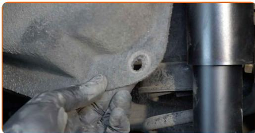
**10** Odklopite vtič senzorja obrabe zavornih oblog.
