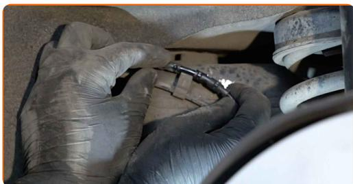
**14** Namestite senzor obrabe na zavorne ploščice.
