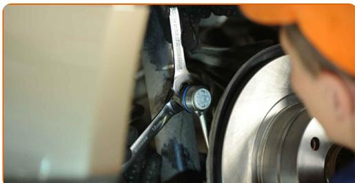
**15** Obdelajte vse spoje opornika stabilizatorja. Uporabite bakreno mast.
