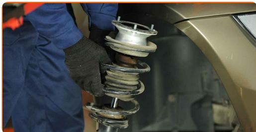
28 Nastavite opornik amortizerja na orodju kompresorja.
