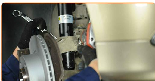
**59** Priključite napeljavo ABS senzorja.
