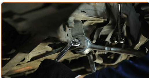
**62** Namestite prečno povezavo stabilizatorja.
