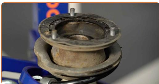
**45** Zategnite matico amortizerja. Uporabite nasadni ključ №21. Uporabite navorni ključ. Zategnite ga do navora 64 Nm.
