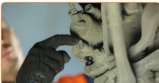
**21** Namestite blokirno vzmet zavorne čeljusti. Uporabite ploščat izvijač.
