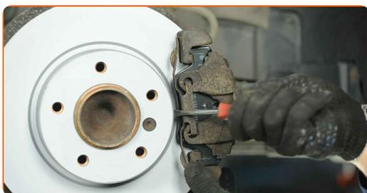
**22** Obdelajte površino, kjer se zavorni kolut stika s platiščem. Uporabite bakreno mast.
