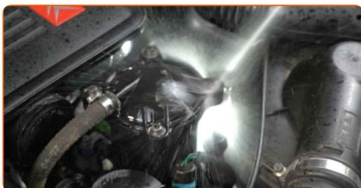
4 Odvijte pritrdilne elemente pokrova filtra za gorivo. Uporabite imbus št. H4. Uporabite izvijač z zatikalom.
