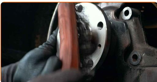
**24** Obdelajte kontaktno površino. Uporabite bakreno mast.
