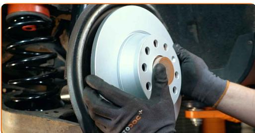
**26** Zategnite pritrditve zavornega diska. Uporabite vijačni nastavek T30. Uporabite navorni ključ. Zategnite ga do navora 4 Nm.
