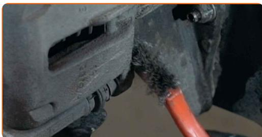
**14** Odvijte pritrditve zavorne čeljusti. Uporabite kombinirani ključ №13. Uporabite kombinirani ključ №15. Uporabite nasadni ključ №13. Uporabite izvijač z zatikalom.
