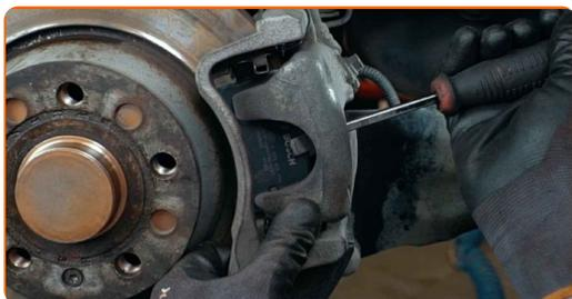
**13** Očistite pritrdilne elemente zavornih čeljusti. Uporabite žično krtačo. Uporabite sprej WD-40.
