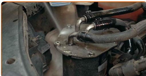
**4** Odvijte pritrdilne elemente pokrova ohišja filtra za gorivo. Uporabite vijačni nastavek T15. Uporabite izvijač z zatikalom.
