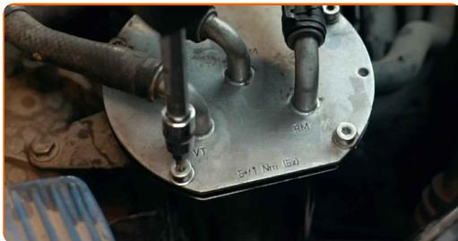
**12** Zategnite pritrdilne elemente pokrova ohišja filtra za gorivo. Uporabite vijačni nastavek T15. Uporabite navorni ključ. Zategnite ga do navora 6 Nm.
