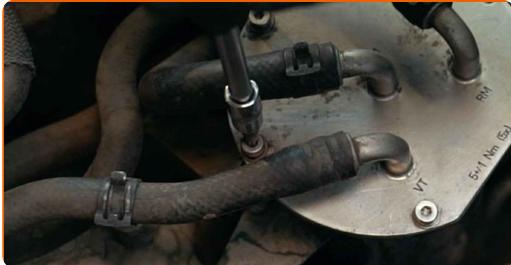
**5** Odstranite pokrov ohišja filtra za gorivo. Uporabite ploščat izvijač.
