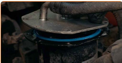
**6** Odstranite filter za gorivo. Uporabite ploščat izvijač.
