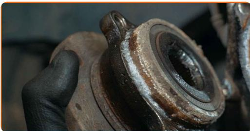
**38** Odvijte pritrdilne elemente ABS senzorja. Uporabite imbus št. H5. Uporabite izvijač z zatikalom.
