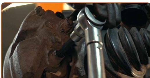
**64** Namestite pokrovčke manšete vodilnih zatičev zavornih čeljusti.
