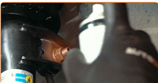
**67** Obdelajte površino, kjer se zavorni kolut stika s platiščem. Uporabite bakreno mast.
