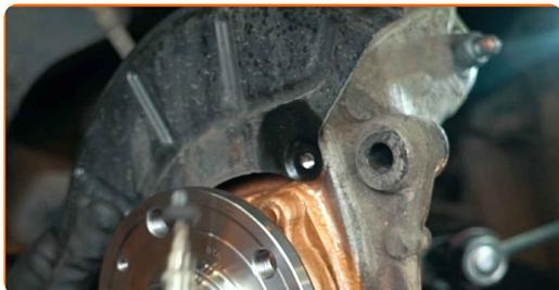
**47** Privijte pritrdilne elemente zaščite zavornega koluta. Uporabite vijačni nastavek T27. Uporabite izvijač z zatikalom.
