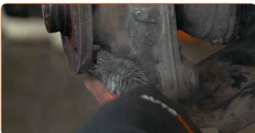
**28** Očistite pritrdilne elemente, ki povezujejo nosilni zgib s krmiljem vzmetenja. Uporabite žično krtačo. Uporabite sprej WD-40.
