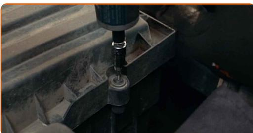
4 Očistite pokrov zračnega filtra in ohišje.
