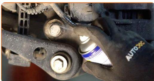
**9** Odvijte spodnjo pritrditev amortizerja. Uporabite kombinirani ključ №21. Uporabite nasadni ključ №21. Uporabite izvijač z zatikalom.
