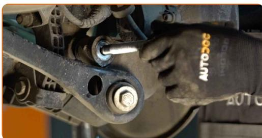
**11** Podprite ročico. Uporabite dvigalko s hidravličnim prenosom.
