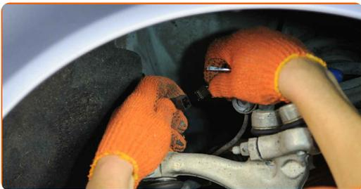
**9** Odklopite napeljavo ABS senzorja.
