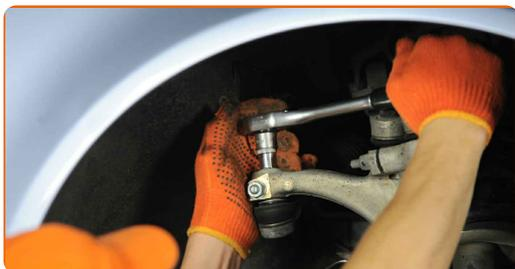
**26.2** Uporabite nasadni ključ №16. Uporabite izvijač z zatikalom.
