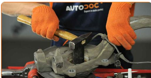
**34** Odvijte pritrdilni element pesto ležaja na krmilnem členku. Uporabite XZN št. 12. Uporabite izvijač z zatikalom.
