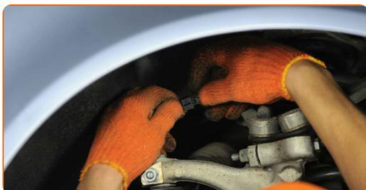
**69** Priključite napeljavo ABS senzorja. Uporabite ploščat izvijač.
