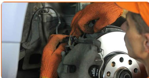
**67** Priključite napeljavo ABS senzorja.
