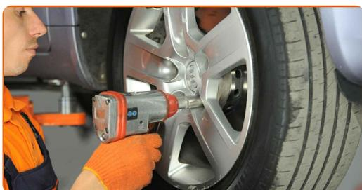
**75** Spustite avto in z delanjem v navzkrižnem vrstnem redu, zategnite kolesne vijake. Uporabite kolesni nasadni nastavek št. 17 Uporabite navorni ključ. Zategnite ga do navora 120 Nm.
