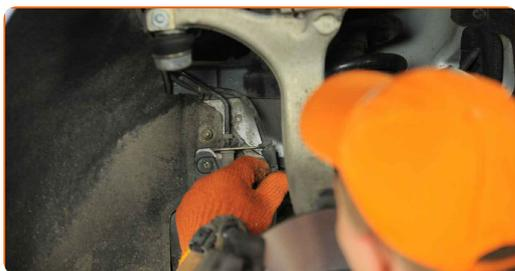
**8** Odklopite konektor ABS senzorja. Uporabite ploščat izvijač.
