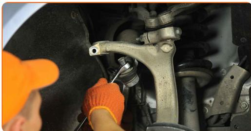
**29** Odvijte pritrdilne elemente zgornje ročice. Uporabite kombinirani ključ №16. Uporabite nasadni ključ №16. Uporabite izvijač z zatikalom.
