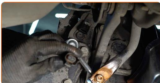
**10** Odvijte pritrditve zavorne čeljusti. Uporabite kombinirani ključ №15. Uporabite nasadni ključ №13. Uporabite izvijač z zatikalom.
