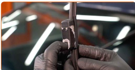
**6** Odstranite metlico iz ročice brisalnika.
