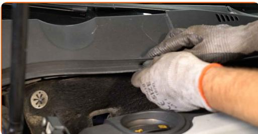
**74** Namestite pritrdilne elemente rešetke pod vetrobranskim steklom.
