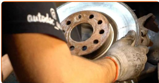
**19** Očistite pesto. Uporabite žično krtačo. Obdelajte kontaktno površino. Uporabite bakreno mast.
