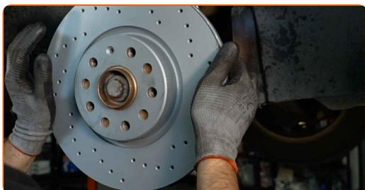
**21** Zategnite pritrditve zavornega diska. Uporabite vijačni nastavek T30. Uporabite navorni ključ. Zategnite ga do navora 4 Nm.
