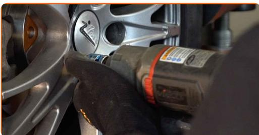
22 Spustite avto in z delanjem v navzkrižnem vrstnem redu, zategnite kolesne vijake. Uporabite navorni ključ. Zategnite ga do navora 120 Nm.
