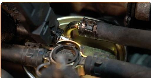
20 Zategnite pritrdilne objemke cevi filtra za gorivo. Uporabite kleščice za cevne objemke z zaklepnim mehanizmom.
