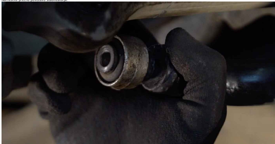
67 Zategnite pritrdilni element veznega elementa stabilizatorja.
