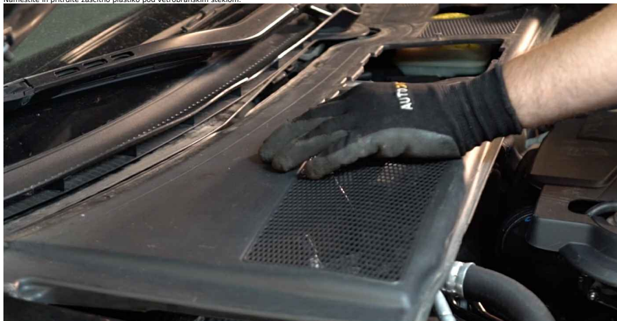
82 Namešite in pritrdite zaščitno plastiko pod vetrobranskim steklom.
