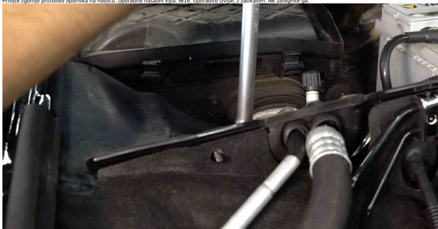
56 Privijte zgornjo pritrditve opornika na nosilcu. Uporabite nasadni ključ №16. Uporabite izvijač z zatikalom. Ne zategnite ga.
