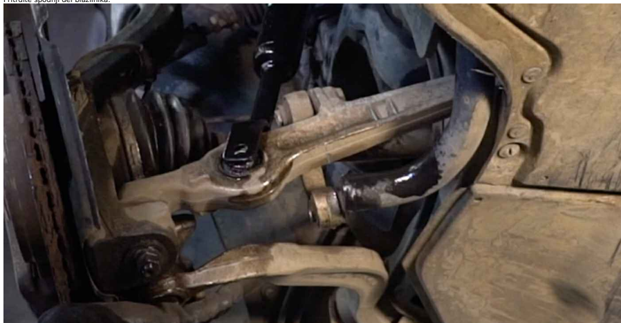
59 Namestite pritrdilni vijak.
