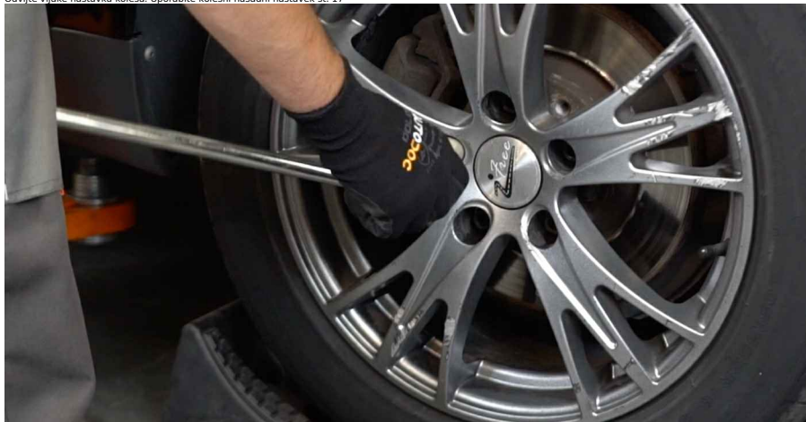
9 Vzdignite sprednji del avtomobila in odtrdite podporneke.
