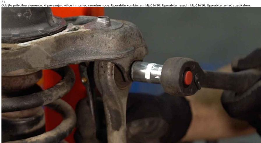
32 Odstranite pritrdilni vijak.
