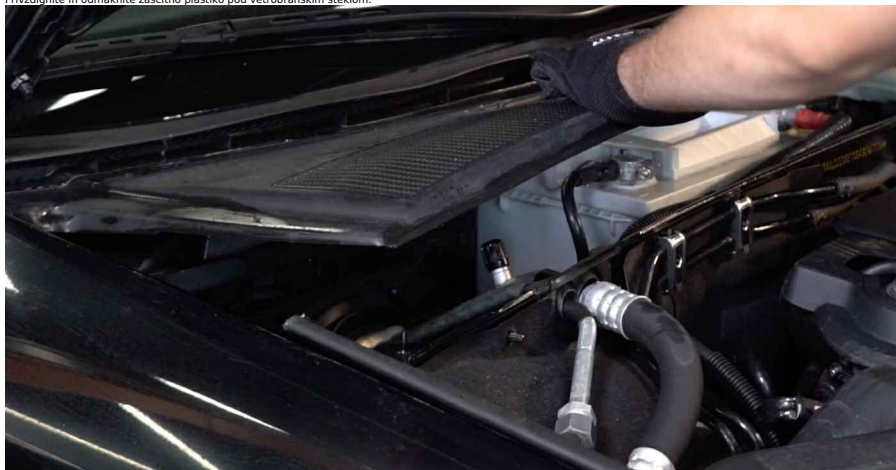
3 Privzdignite in odmaknite zaščitno plastiko pod vetrobranskim steklom.
