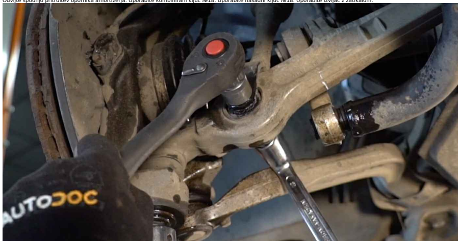
21 Odstranite pritrđilni vijak.
