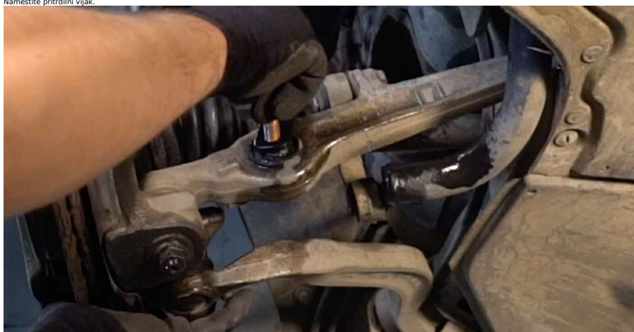
59 Namestite pritrdilni vijak.
