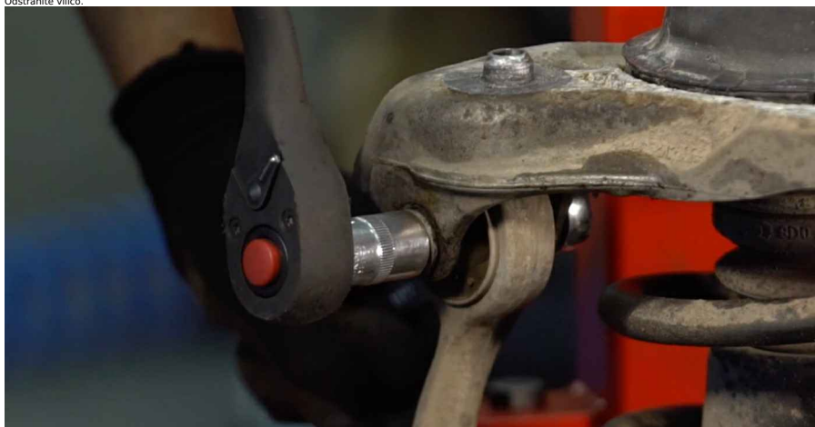
34 Odvijte pritrdilne elemente, ki povezujejo vilice in nosilec vzmetne noge. Uporabite kombinirani ključ №16. Uporabite nasadni ključ №16. Uporabite izvijač z zatikalom.
