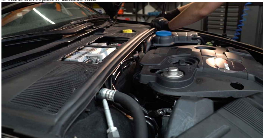
84 Privijte okrogle vijake z uporabo križnega vzorca. Uporabite navorni ključ. Zategnite ga do navora 120 Nm.
