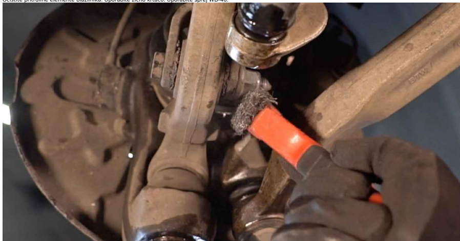
19 Očistite pritrđilne elemente blažinika. Uporabite žično krtačo. Uporabite sprej WD-40.
