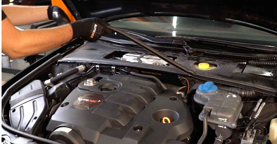
3 Privzdignite in odmaknite zaščitno plastiko pod vetrobranskim steklom.
