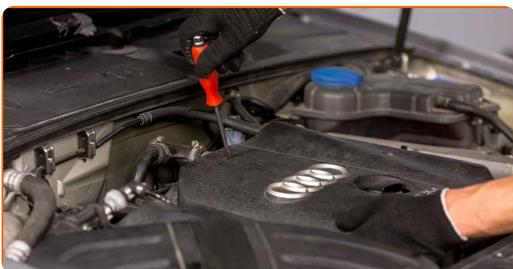
**17** Privijte pritrdilne elemente pokrova motorja. Uporabite ploščat izvijač.
