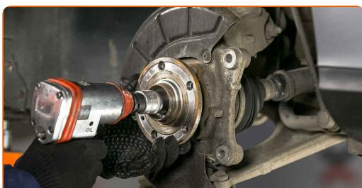
**22** Očistite pritrdilni element, ki povezuje nosilni z gib s premnikom. Uporabite žično krtačo. Uporabite sprej WD-40.
