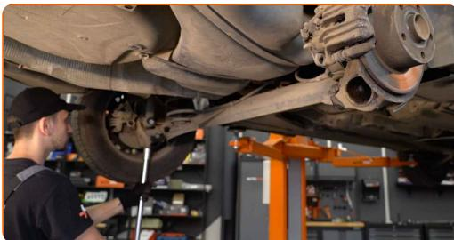
**12** Odvijte spodnjo pritrditev amortizerja. Uporabite kombinirani ključ №16. Uporabite nasadni ključ №16. Uporabite izvijač z zatikalom.
