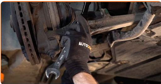
**52** Očistite nosilce in ležaje prečnega vodila. Uporabite žično krtačo. Uporabite sprej WD-40.
