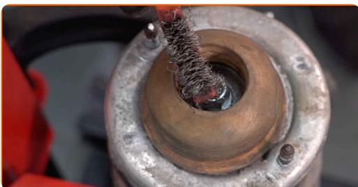
**32** Odstranite matico oporne batnice. Uporabite imbus št. H6. Uporabite nasadni ključ №18. Uporabite izvijač z zatikalom.
