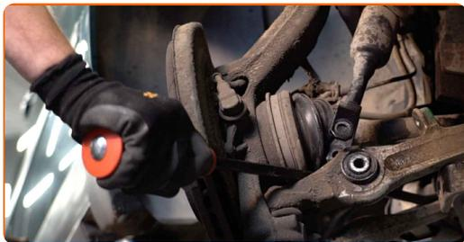
**24** Odvijte pritrdilne elemente na vrhu nosilca amortizerja.
