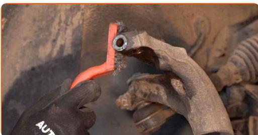
**53** Obdelajte vse dele prečnega vodila. Uporabite bakreno mast.
