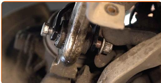
47 Očistite nosilce in ležaje prečnega vodila. Uporabite žično krtačo. Uporabite sprej WD-40.
