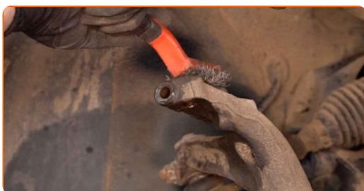
48 Obdelajte vse dele prečnega vodila. Uporabite bakreno mast.
