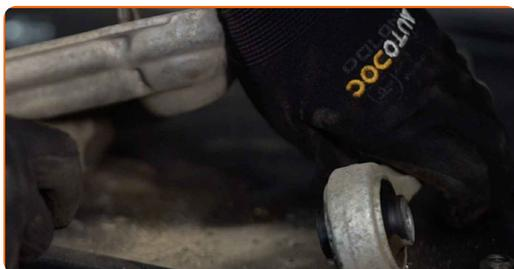
33 Očistite nosilce in ležaje prečnega vodila. Uporabite žično krtačo. Uporabite sprej WD-40.
