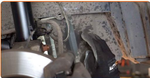
17 Privijte pritdilne elemente stranske plastične zaščite motorja. Uporabite nasadni ključ N°10. Uporabite Phillips križni izvijač.
