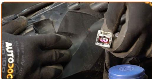
14 Obdelajte priključke žaromet. Uporabite sprej za elektroniko.
