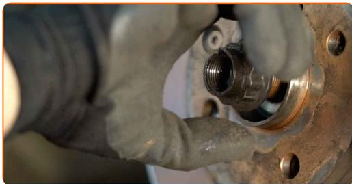
62 Obdelajte površino, kjer se zavorni kolut stika s platiščem. Uporabite bakreno mast.
