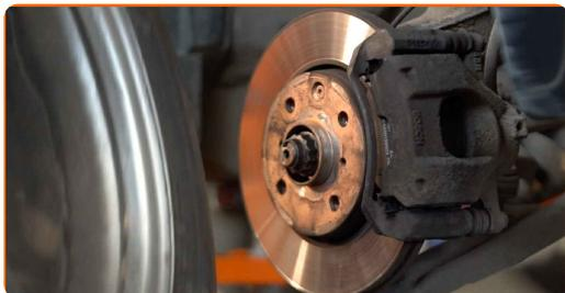
12 Odklopite pritrditev kabla ABS senzorja iz opornika amortizerja.
