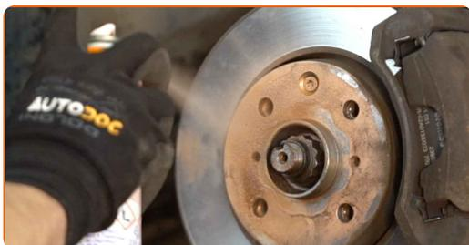
63 Očistite površino zavornih kolutov. Uporabite čistilo zavor.
