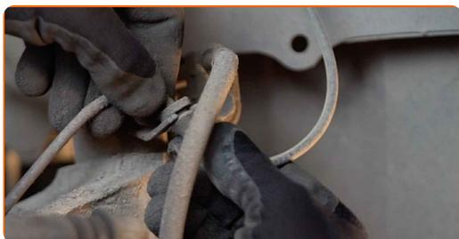
13 Očistite pritrdilne elemente ABS senzorja in zavorne cevi, ki ju povezujejo na blažilnik. Očistite pritrdilne elemente, ki povezujejo blažilnik s premnikom. Uporabite žično krtačo. Uporabite sprej WD-40.
