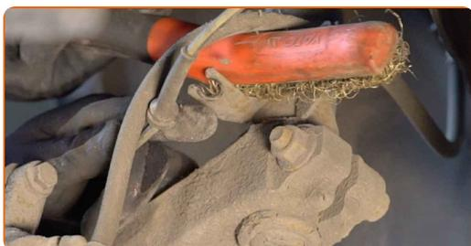
14 Z opornika odvijte nosilec zavorne cevi. Uporabite nasadni ključ №15.
