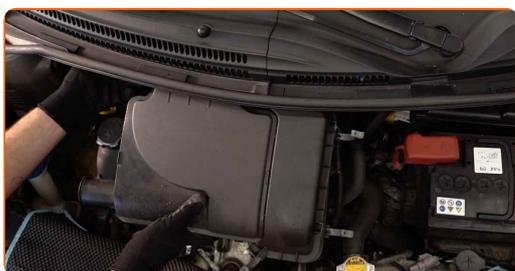
13 Priključite dovodno cev zraka na ohišje zračnega filtra.
