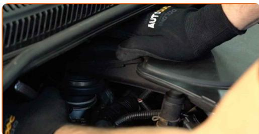
7 Pokrijte nastavek dušilnih loput s krpo iz mikrovlačen, da preprečite vdor prahu in umazanije v sistem.
