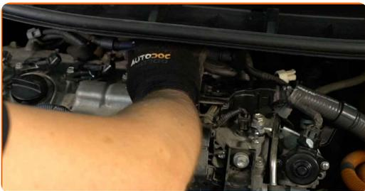
**17** Obdelajte konektor vžigalne tuljave s sprejem za elektroniko. Sprej bo zaščitil električne kontakte pred korozijo, oksidacijo in bo zmanjšal upor kontaktov.
