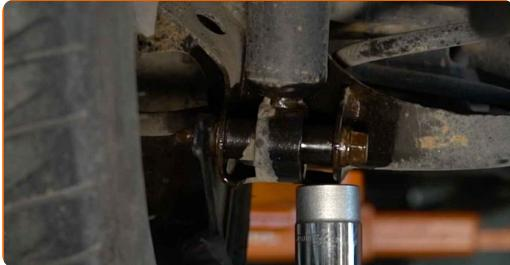
**12** Odvijte spodnjo pritrditev amortizerja. Uporabite kombinirani ključ №17. Uporabite nasadni ključ №17. Uporabite izvijač z zatikalom.
