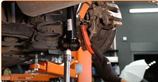
8 Odvijte spodnjo pritrditev amortizerja. Uporabite kombinirani ključ №17. Uporabite nasadni ključ №17. Uporabite izvijač z zatikalom.
