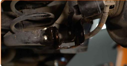
11 Podprite zadnji nosilec vzmetenja. Uporabite dvigalko s hidravličnim prenosom.
