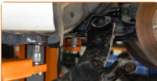
**24** Očistite nosilce in ležaje prečnega vodila. Uporabite žično krtačo. Uporabite sprej WD-40.
