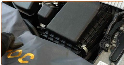
**13** Pritrdite vpenjalni kos na cev za dovod zraka. Uporabite nasadni kluč №10. Uporabite izvijač z zatikalom.
