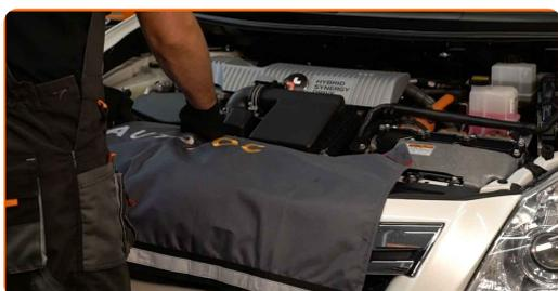
**3** Odstranite vpenjalni kos cevi za dovod zraka. Uporabite nasadni ključ №10. Uporabite izvijač z zatikalom.
