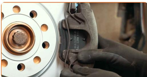
**24** Obdelajte površino, kjer se zavorni kolut stika s platiščem. Uporabite bakreno mast.
