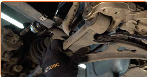
**17** Očistite nosilce in ležaje prečnega vodila. Uporabite žično krtačo. Uporabite sprej WD-40.
