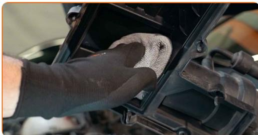
**8** Očistite pokrov zračnega filtra in ohišje.
