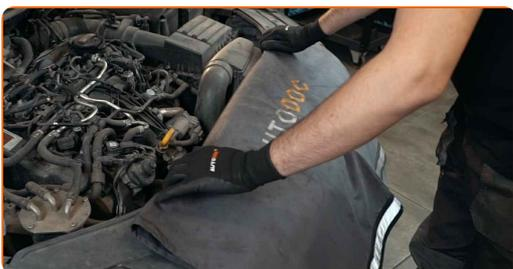
**3** Odstranite pritrdilne vijake pokrova zračnega filtra. Uporabite vijačni nastavek T25. Uporabite izvijač z zatikalom.
