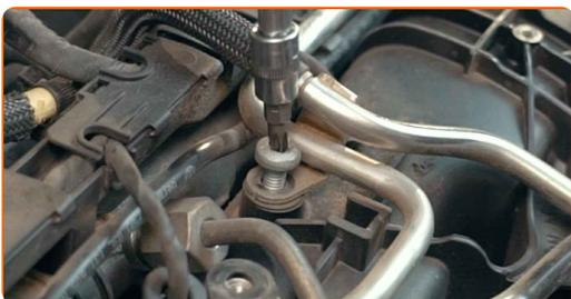
**6** Odstranite kabljsko napeljavo motorja. Uporabite ploščat izvijač.
