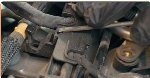
**7** Odstranite konektorje kabljske napeljave motorja. Uporabite ploščat izvijač.
