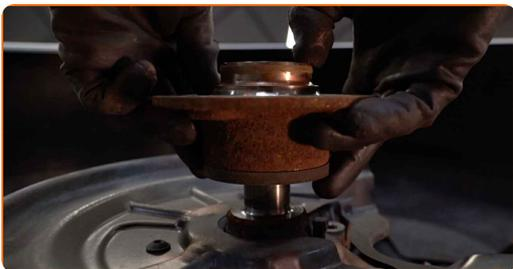
**18** Očistite vodilni del premnika. Uporabite sprej WD-40.
