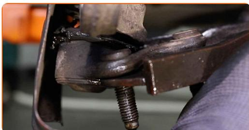
**39** Pričvrstite pritrdilne elemente, ki povezujejo kroglični sklep s kontrolno roko. Uporabite nasadni ključ №16. Uporabite navorni ključ. Zategnite ga do navora 60 Nm.
