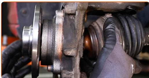
**36** Namestite in zategnite vijak pogonske gredi. Uporabite 12-točkovni nastavek Št. 24. Uporabite izvijač z zatikalom.
