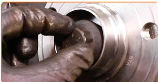
**37** Očistite sedež za namestitev nosilnega zgiba. Uporabite žično krtačo. Uporabite sprej WD-40.
