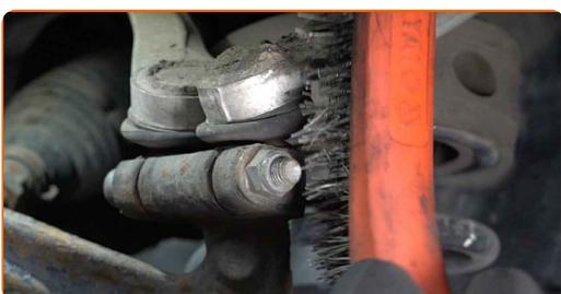
**17** Odvijte pritrdilne elemente zgornje ročice. Uporabite nasadni ključ №16. Uporabite imbus št. H8. Uporabite izvijač z zatikalom.
