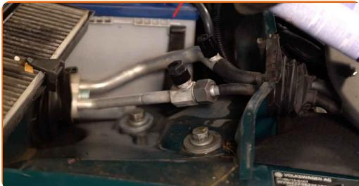
6 Sprostite zgornji pritrdilni element sedeža za namestitev blažilnika. Uporabite nasadni ključ №16. Uporabite izvijač z zatikalom.
