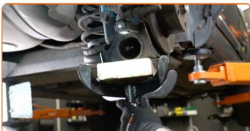
9 Odvijte spodnjo pritrditev amortizerja. Uporabite kombinirani ključ №16. Uporabite nasadni ključ №16. Uporabite izvijač z zatikalom.
