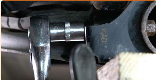
10 Odvijte zgodnjo pritrditev amortizerja. Uporabite nasadni ključ №13. Uporabite izvijač z zatikalom.
