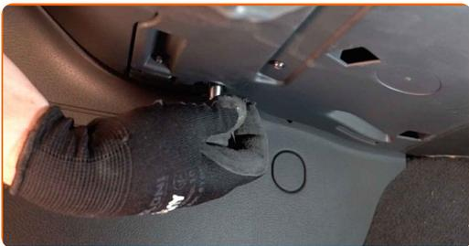
**15** Namestite stransko okrasno ploščo. Namestite del z uporabo vodil in pritrdite pritrdilne elemente.
