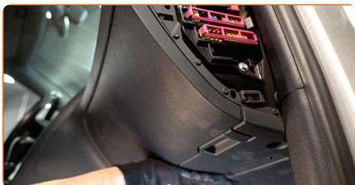
**14** Privijte pritrdilne vijake predla pred sovoznikom. Uporabite nasadni ključ N°8. Uporabite izvijač z zatikalom.
