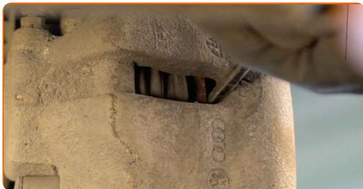
**9** Odstranite pokrovčke manšete vodilnih zatičev zavornih čeljusti. Uporabite lomilko.
