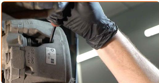
**10** Odstranite zadrževalno vzmet okvirja kolutne zavore. Uporabite lomilko. Uporabite ploščat izvijač.
