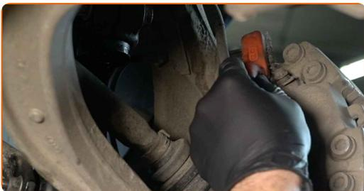
**8** Odvijte pritrditve zavorne čeljusti. Uporabite nasadni ključ N°13. Uporabite izvijač z zatikalom.
