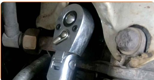
**10** Obdelajte lambda sondo. Uporabite visokotemperaturno keramično pasto.
