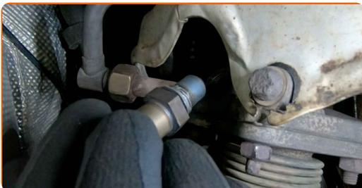
**12** Pričvrstite pritrdilni element lambda sonde. Uporabite 22-mm nasadni ključ lambda sonde. Uporabite navorni ključ. Zategnite ga do navora 37 Nm.
