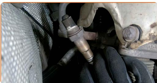
**9** Prerežite navoj za novo lambda sondo. Uporabite navojni sveder. Uporabite izvijač z zatikalom.
