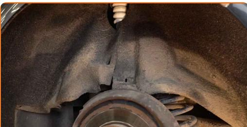
33 Namestite in zategnite pritrdilne elemente pokrova blatnika. Uporabite vijačni nastavek T25.
