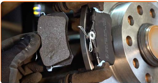
**26** Namestite zavorno čeljust in jo privijte. Uporabite nasadni ključ №13. Uporabite kombinirani ključ №15. Uporabite navorni ključ. Zategnite ga do navora 35 Nm.
