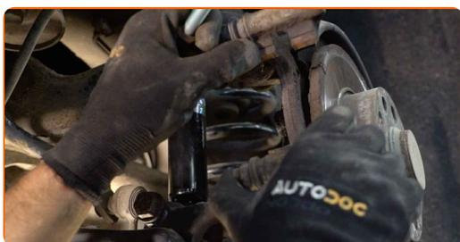
**15** Očistite pritrdilne elemente zavornih ploščic. Uporabite žično krtačo. Uporabite sprej WD-40.
