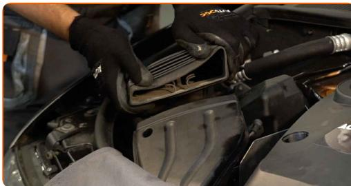
**4** Odstranite pritrdilne vijke pokrova zračnega filtra. Uporabite Phillips križni izvijač.
