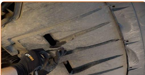
**26** Zategnite pritrtilne elemente na spodnjem pokrovu oljnega korita. Uporabite nasadni ključ №10. Uporabite izvijač z zatikalom.
