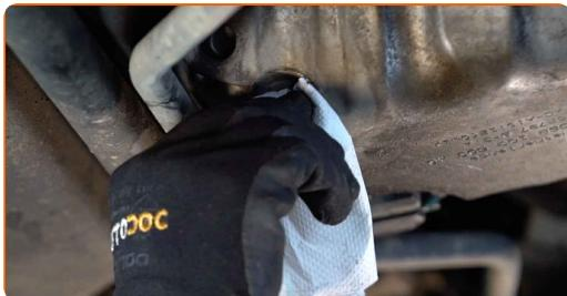
**23** Privijte nov drenažni čep in ga zategnite. Uporabite nasadni ključ №19. Uporabite navorni ključ. Zategnite ga do navora 30 Nm.
